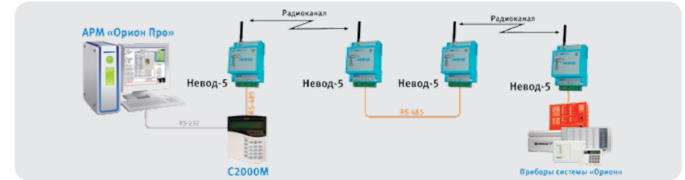
Рисунок 91. Структурная схема использования «Невод-5» с АРМ «Орион Про» и «С2000М», соединение «точка-точка» с ретрансляцией
