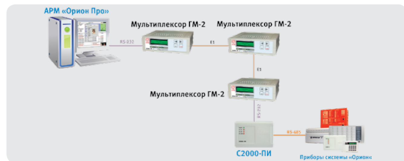
Рисунок 80. Структурная схема использования мультиплексора «ГМ-2» с АРМ «Орион»/«Орион Про» с подключением промежуточного мультиплексора (ремультимплексирование)
