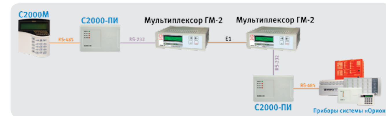
Рисунок 81. Структурная схема использования мультиплексора «ГМ-2» с пультом «С2000М»
