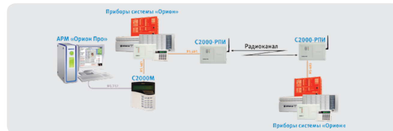
Рисунок 87. Структурная схема использования «С2000-РПИ» с АРМ «Орион Про» и «С2000М», соединение «точка-точка»
