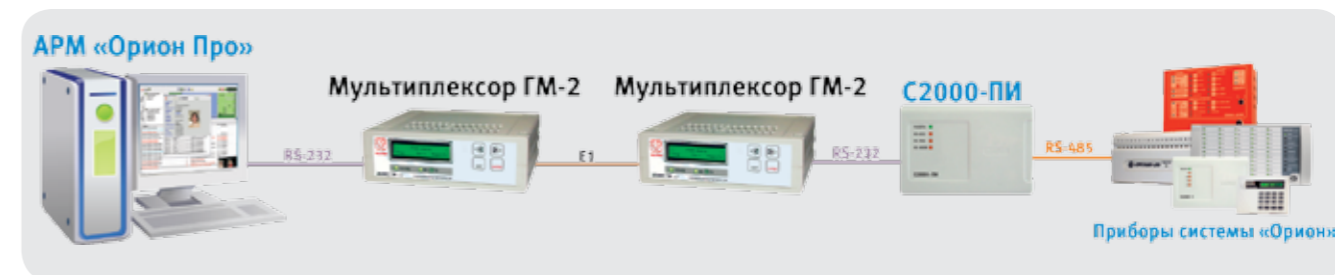
Рисунок 79. Структурная схема использования мультиплексора «ГМ-2» с АРМ «Орион»/«Орион Про»
