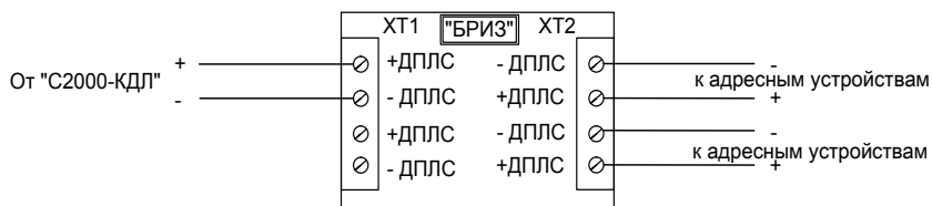
Схема "БРИЗ" (когда "БРИЗ" применяется в качестве распределительной коробки)
