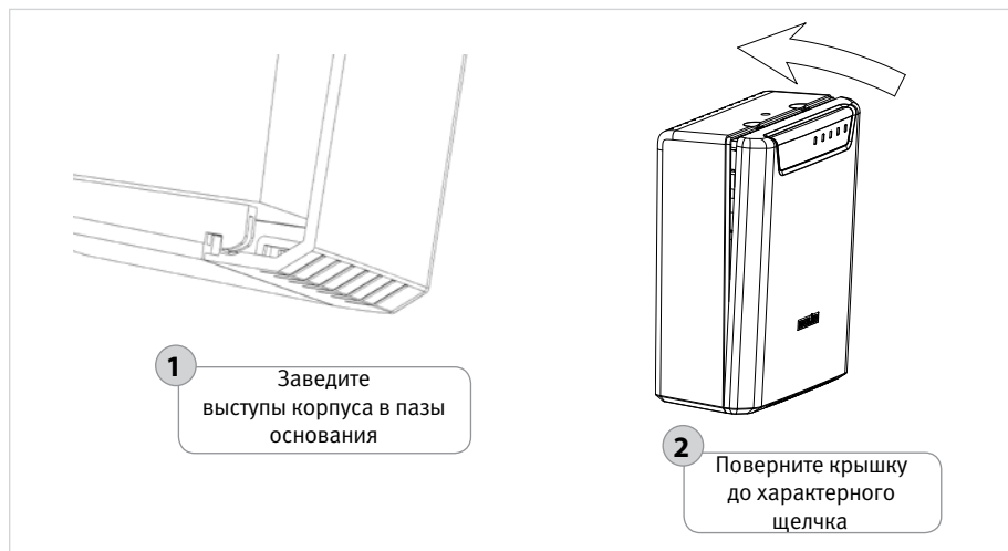
Рисунок 7. Установка крышки
