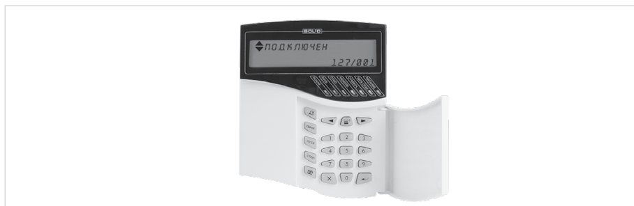
Рисунок 1. Индикатор пульта «С2000М» с соответствующим сообщением
