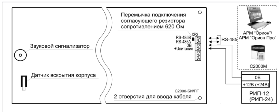
Рисунок 1. Схема внешних соединений блока «С2000-БИ SMD»
