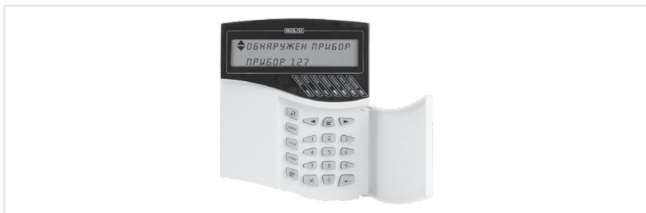
Рисунок 1. Индикатор пульта «С2000М» с соответствующим сообщением
