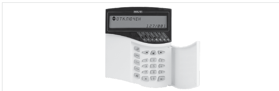
Рисунок 2. Индикатор пульта «С2000М» с соответствующим сообщением
