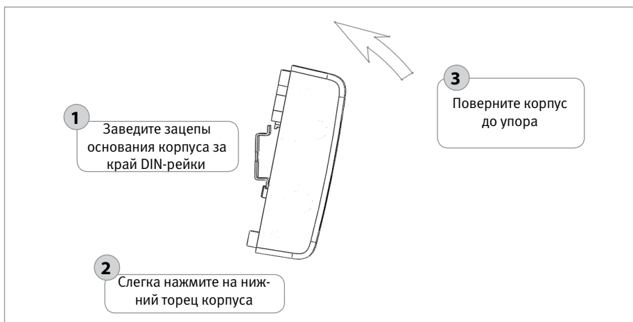
Рисунок 23. Порядок установки прибора на DIN-рейку
