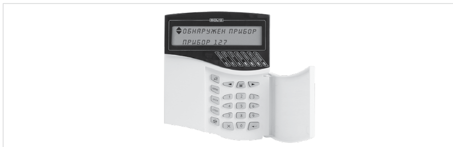
Рисунок 1. Индикатор пульта «С2000М» с соответствующим сообщением
