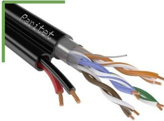
**ParLan® combi U/UTP Cat5e PVC** – кабель с высокочастотным элементом типа U/UTP Cat5e в виде пар, скрученных в сердечник, и группой жил питания, в изоляции из ПВХ, в общей оболочке из ПВХ с разделительным основанием между высокочастотным элементом кабеля и группой жил питания.
