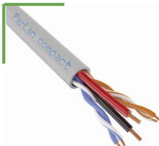
**ParLan® Patch compact U/UTP Cat5e PVC** – кабель с двумя скрученными парами высокочастотного элемента типа Patch U/UTP Cat5e и жилами питания в изоляции из ПВХ, скрученными в общий сердечник, в общей оболочке из ПВХ.
