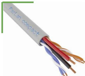
**ParLan® compact U/UTP Cat5e PVC** – кабель с двумя скрученными парами высокочастотного элемента типа U/UTP Cat5e и жилами питания в изоляции из ПВХ, скрученными в общий сердечник, в общей оболочке из ПВХ.
