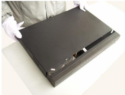
Установите верхнюю крышку устройства.
