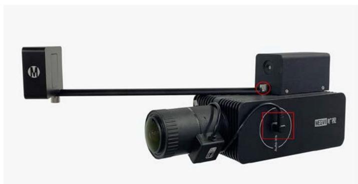
Рис. 3 Установка черного тела и подключение объектива.
