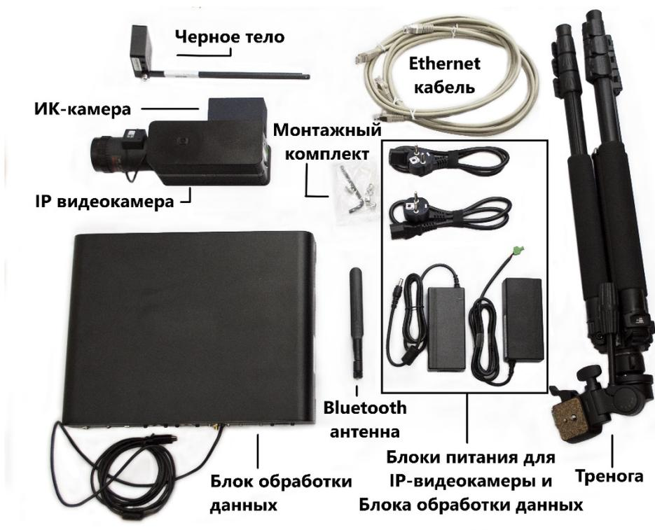
Рис 2. Комплекс измерения температуры АйТек ПРО Т4
