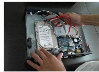
Совместите отверстия в креплении жесткого диска и в нижней части устройства (**внутри устройства!**).
