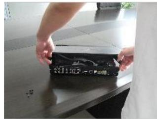
Открутите шурупы и снимите верхнюю крышку устройства
