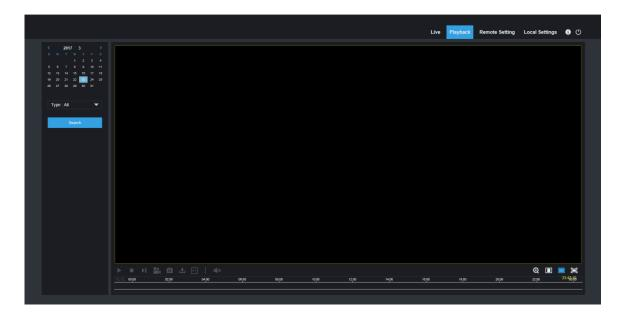
Пользователь может искать видео по типу записи и управлять видео при помощи панели инструментов, например, открыть/остановить видео, записать, сделать скриншот, загрузить записи, быстро воспроизвести видео, включить/выключить звук.
