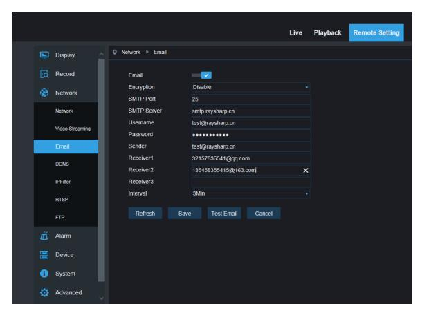
Настройка электронной почты: настройка почтовой службы - используется с функцией тревожного сигнала для загрузки изображений, прикрепленных к почтовому серверу.
