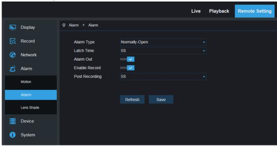
Alarm Type: Тип тревожного входа: Normally -Open (Нормально-Открытый), либо Normally -Closed (Нормально-Закрытый).
