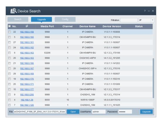
Конфигурация: Дважды щелкните по выбранной камере на странице поиска, перейдите на вкладку конфигурации для перезагрузки камеры, смены пароля и сброса камеры.
