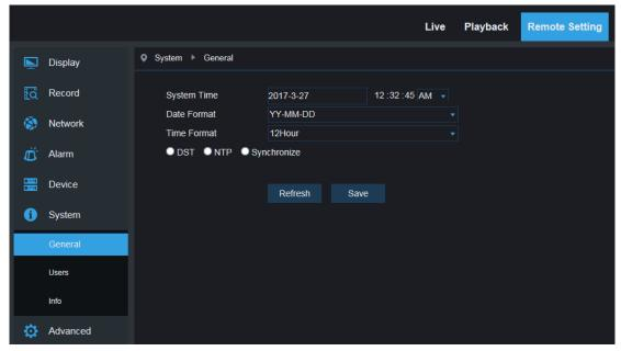
Время устройства, системное время, формат даты и формат времени, содержащиеся в общей информации, могут быть установлены и сохранены вручную.
