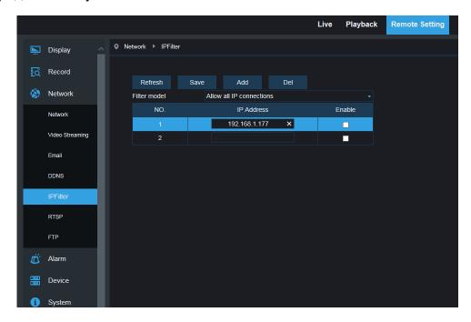
Filtering mode: Доступно три режима (Разрешить все IP-соединения, Разрешить все установленные соединения)
