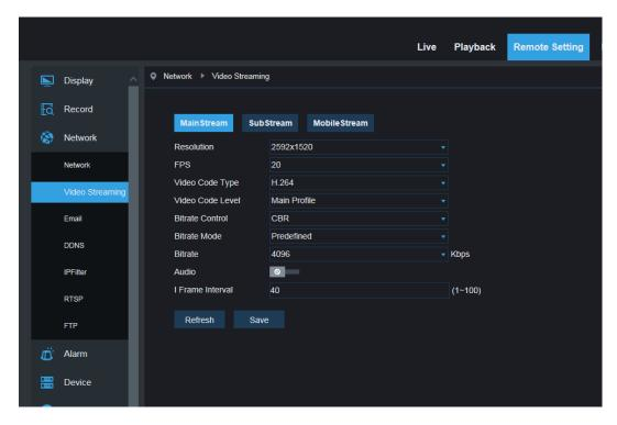
**Режимы потока по умолчанию:** основной поток, доп.поток и мобильный поток
