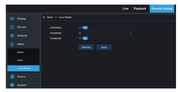
Включите параметр «Lens Shade» («Закрытие объектива», установлен по умолчанию) чтобы активировать параметры чувствительность и отправки на почту
