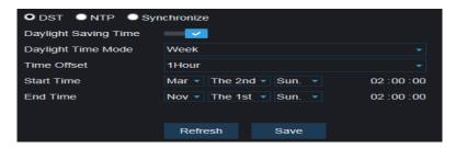
Устройство будет корректировать время, в зависимости от установленного отклонения.
