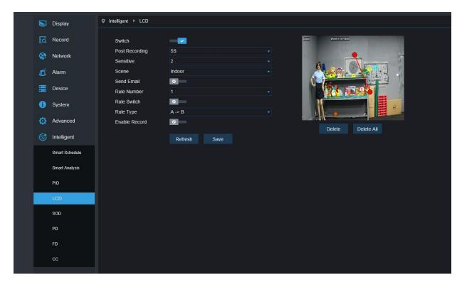
Описание функции: на странице предварительного просмотра, обнаружение и отслеживание движущегося объекта, пересекшего линию
