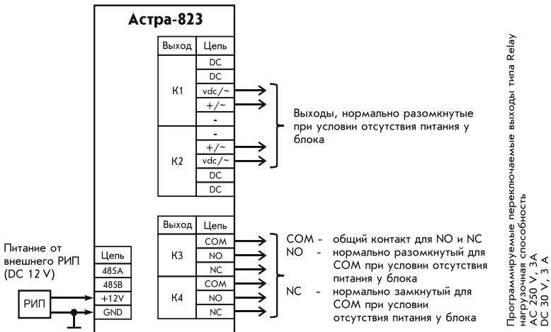
Подключение нагрузок к выходам блока Астра-823 без обеспечения контроля целостности цепей
